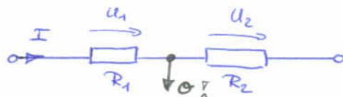
Fliessen durch zwei Widerstände gleiche Ströme, so verhalten sich die Spannungen wie die entsprechenden Widerstandswerte
