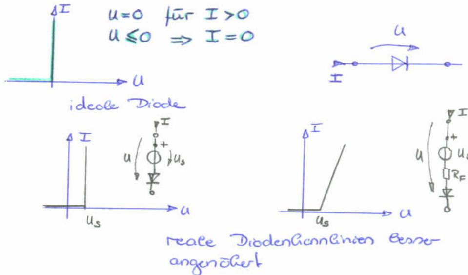
Für einen möglichen Strom in Durchlassrichtung brauchen wir einen Mindestwert der Anschlussspannung (Schwellspannung  $U_s$ )
