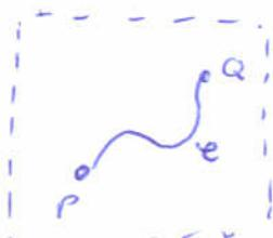
Wenn die Spannung zwischen zwei Punkten P, Q nicht vom Verlauf der Kurve  $e$  abhängt kann man von der Spannung zwischen den Punkten sprechen
