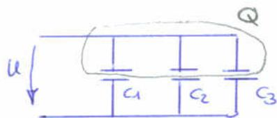
An jedem Kond. die gleiche Spannung
