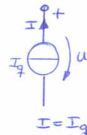
Der Strom fließt im Innern des Elements immer vom Minuspol  $\rightarrow$  Pluspol, dies ist der Richtungssinn des Quellenstroms. Bezugssinne sind wiederum frei wählbar, jedoch sinnvollerweise wird der Bezugssinn von  $I$  gleich dem Richtungssinn von  $I_q$  gewählt.
